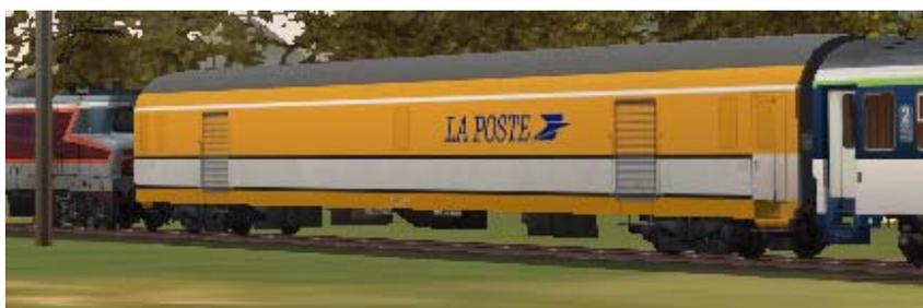
La Poste **PE UIC 74** – Construit entre 1974 et 1980, et converti du tri aux transports des colis. La Poste a dix unités en service.
